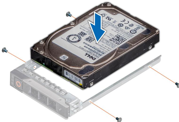
Ilustración 23. Instalación de una unidad en el portaunidades
