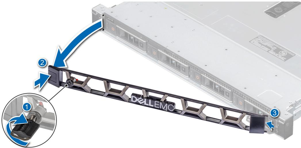
Ilustración 16. Extracción del bisel frontal
