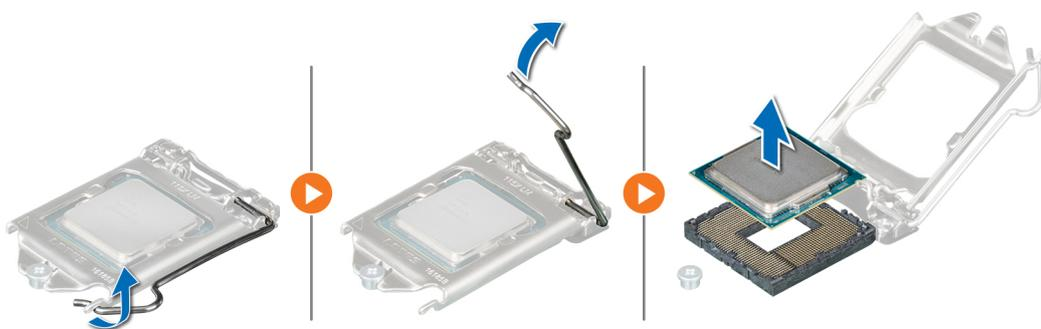
**Ilustración 50. Extracción del procesador**
