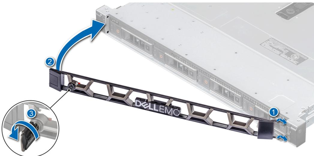
Ilustración 17. Instalación del bisel frontal
