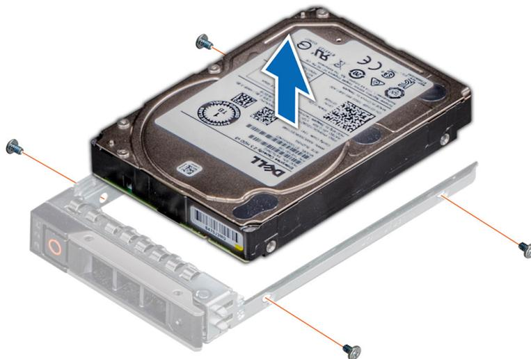
Ilustración 22. Extracción de la unidad del portaunidades
