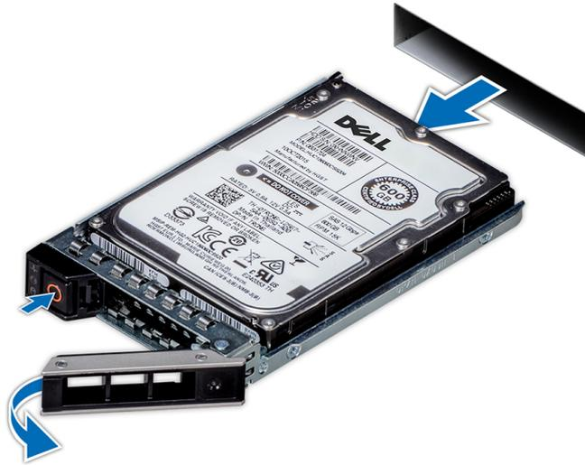
Ilustración 20. Extracción de un portaunidades
